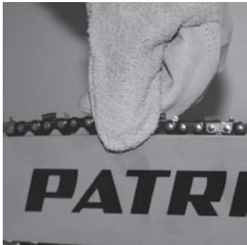
ПРИ УСТАНОВКЕ НОВОЙ ЦЕПИ СЛЕДУЕТ ПРОВЕРЯТЬ ЕЕ НАТЯЖЕНИЕ, ПОКА ЦЕПЬ НЕ ПРИРАБОТАЕТСЯ. ПЕРЕД НАЧАЛОМ РАБОТ ПРОВЕРЯЙТЕ НАТЯЖЕНИЕ ЦЕПИ. ПРАВИЛЬНО НАТЯНУТАЯ ЦЕПЬ СЛУЖИТ ДОЛЬШЕ И ОБЕСПЕЧИВАЕТ ВЫСОКОЕ КАЧЕСТВО ПИЛЕНИЯ.
