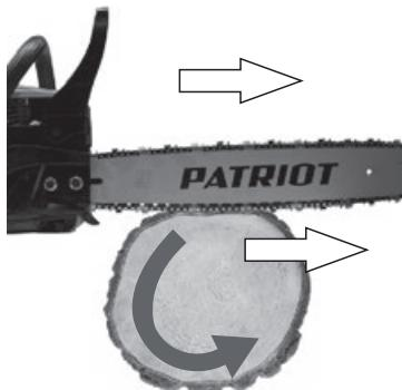
При неправильной распиловке древесины цепь может быть зажата бревном. Чтобы этого не произошло, определитесь, каким образом Вы будете проводить распиловку древесины. Вы можете начать процесс распиловки бревна сверху, для этого сделайте распил примерно на четверть диаметра бревна, а затем закончите распил снизу. В этом случае цепь не окажется зажатой в бревне.
