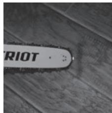
**Шаг 3.** Через несколько секунд на поверхности должны появиться следы цепной смазки. Если этого не произошло, то Вам необходимо прочистить масляные отверстия на шине (см. стр. 18)
