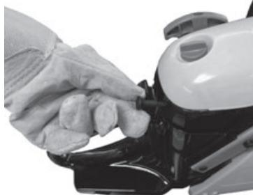
**Шаг 4.** Полностью вытяните рычаг воздушной заслонки, тем самым установив его в положение - «ЗАПУСК».
