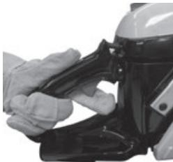
**Шаг 7.** Дайте двигателю прогреться 15 - 20 секунд. Однократно нажмите на блокиратор и курок газа полностью, рычаг воздушной заслонки автоматически перейдёт в рабочее положение.
