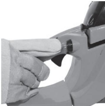
**Шаг 5.** Нажмите несколько раз на кнопку праймера для заполнения карбюратора топливной смесью. Положите бензопилу на устойчивую поверхность. Цепь должна свободно вращаться и быть на безопасном расстоянии от окружающих предметов.
