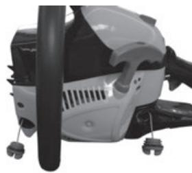
**Шаг 1.** Установите тормоз цепи в нерабочее положение, сдвинув ручку тормоза в направлении передней ручки до касания.
