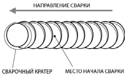
Рис. 9.4. Начало сварки при смене электрода.
